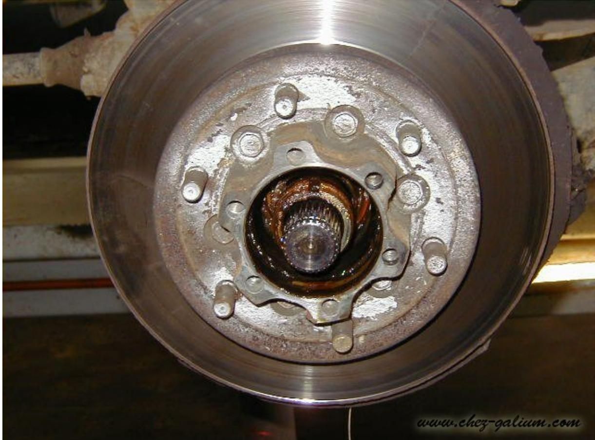
*Il nous reste à tirer sur le moyeu/disque pour le sortir, et aller à l'étau.*
