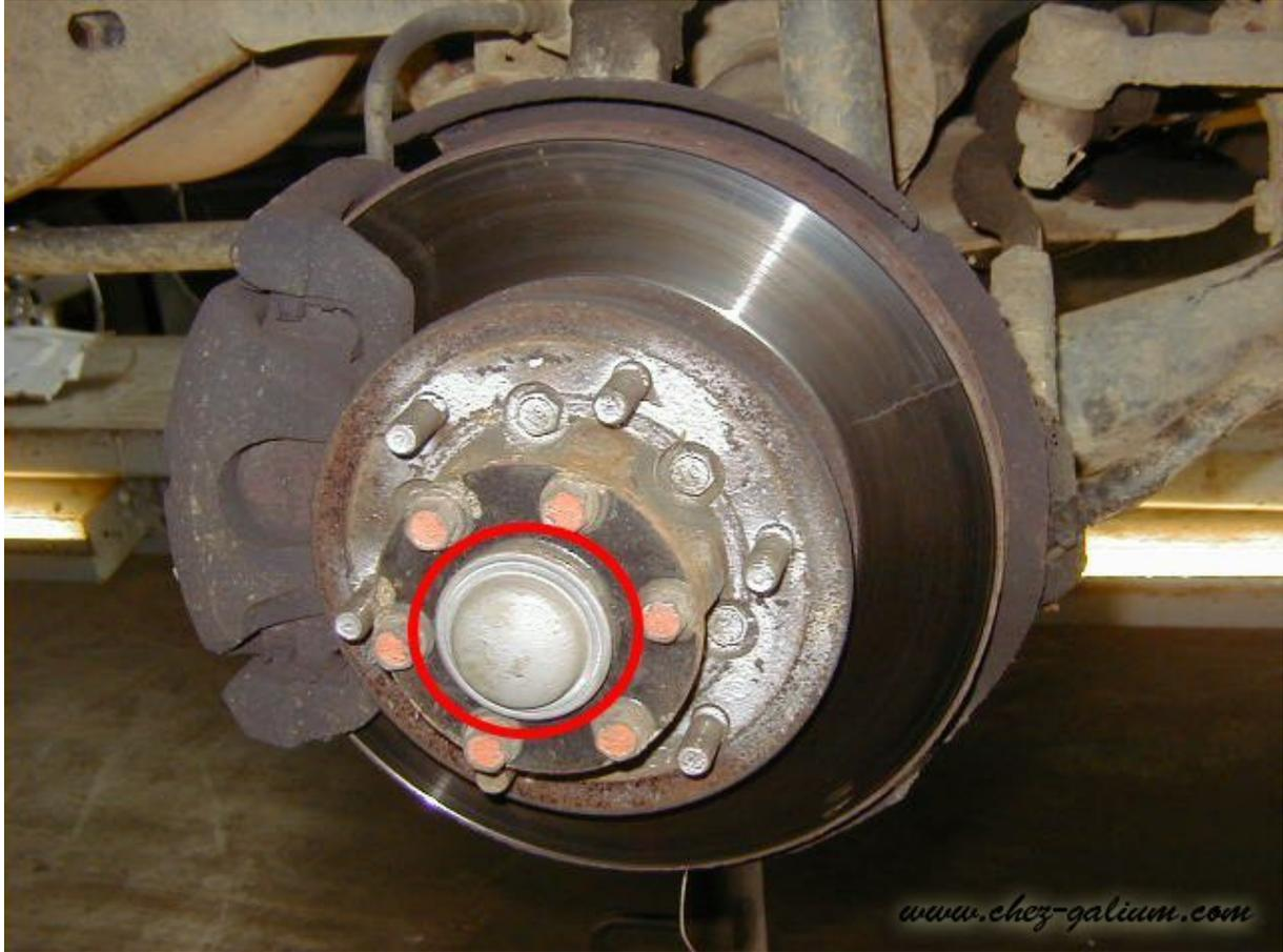
*Voilà, nous enlevons (en rouge) le bouchon de moyeu, ainsi que le circlips ce trouvant derrière
