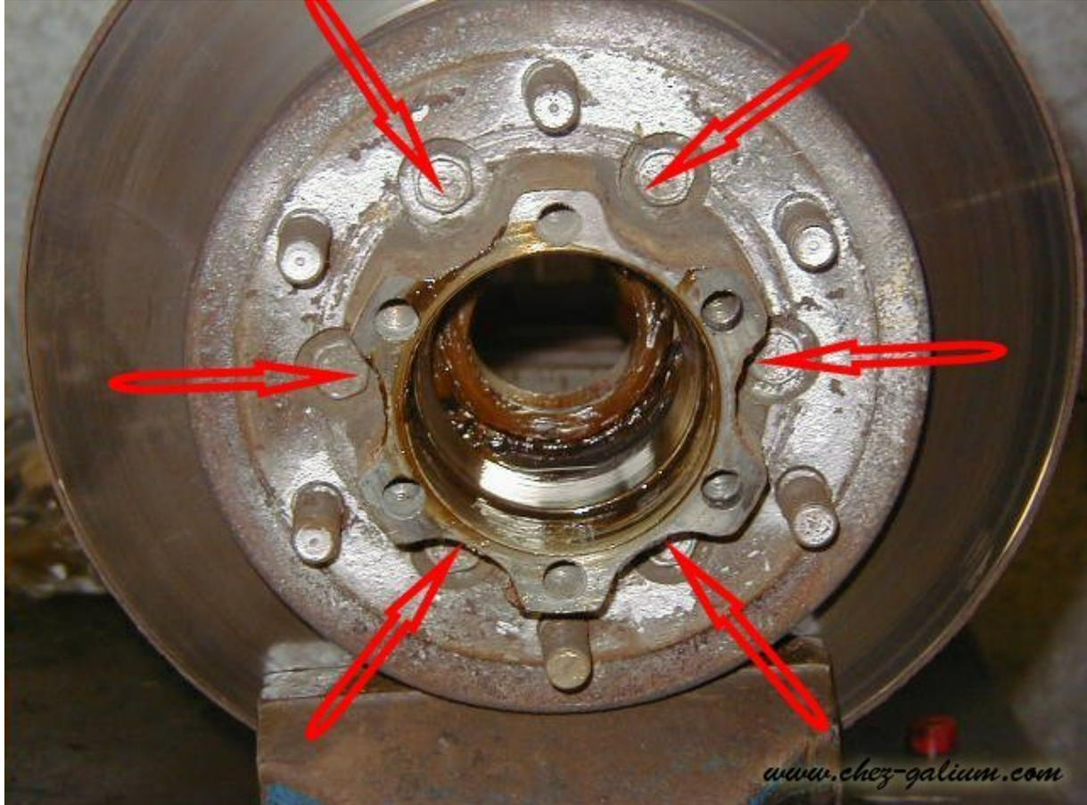
*Une fois le disque bien bloqué à l'étau, enlever (en rouge) les 6 boulons avec écrous et rondelles (clé de 14).*
