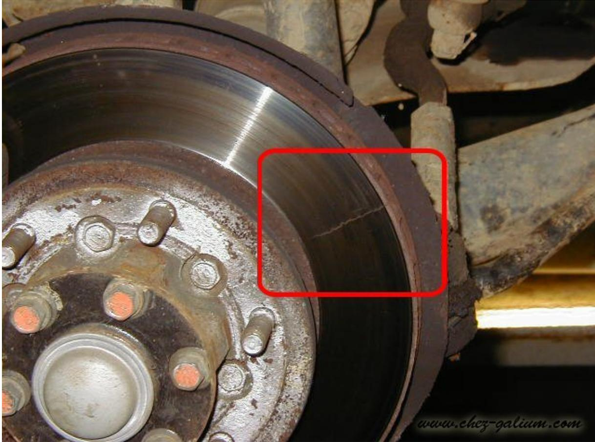
*Au départ, (en rouge) un disque de frein fendus et donc à remplacer, ainsi que les plaquettes de frein.*
