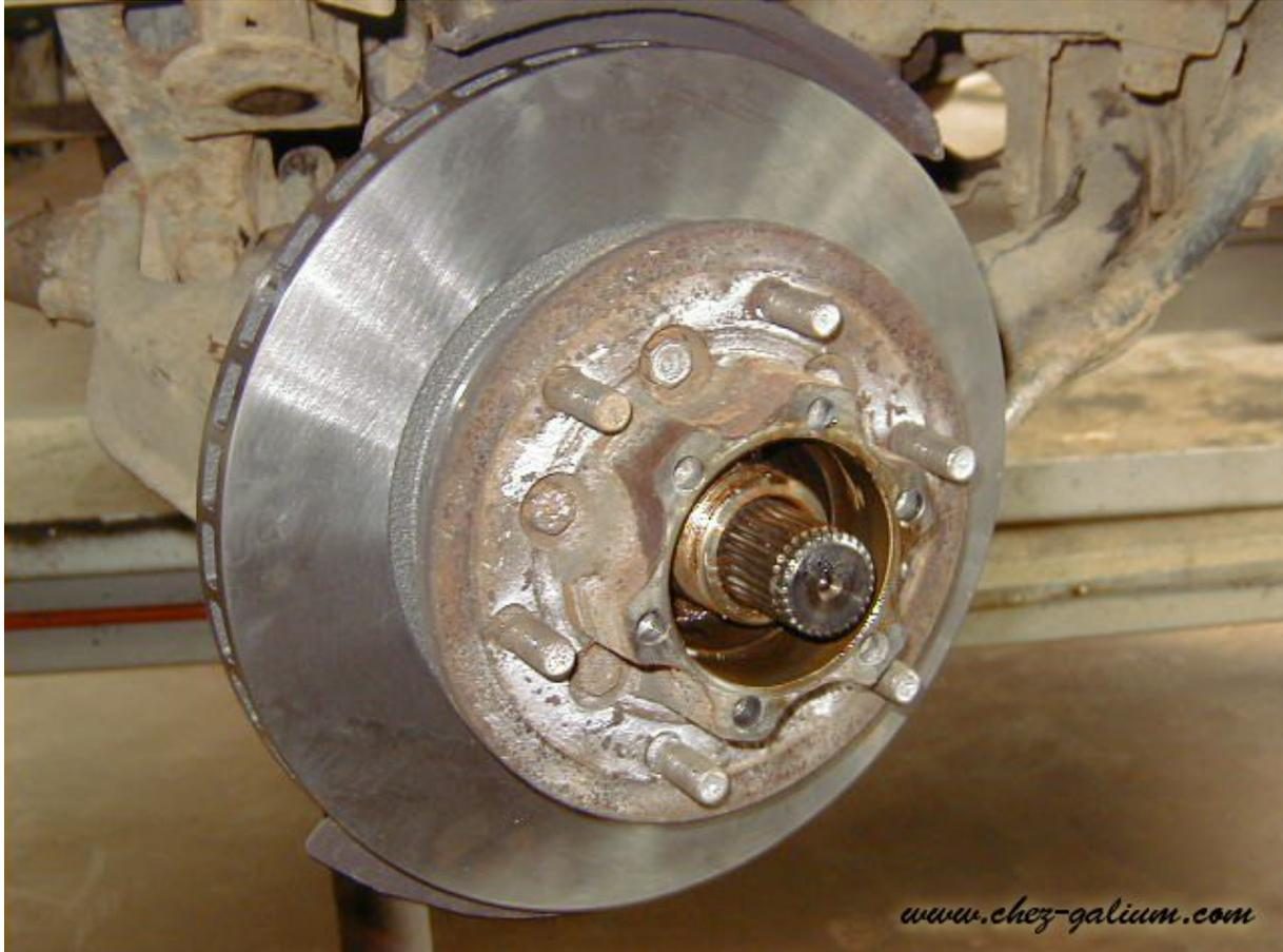
*Une fois le moyeu et le disque en place, nous pouvons remettre le roulement de roue, la bague de réglage, la bague de sécurité (bague à trous) et les deux vis.*
